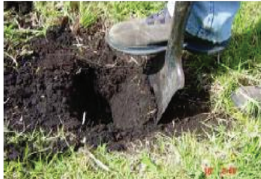
Figura 9. Uso del palín para muestreo
