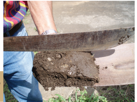
Figura 10. Corte de bordes con cuchillo
