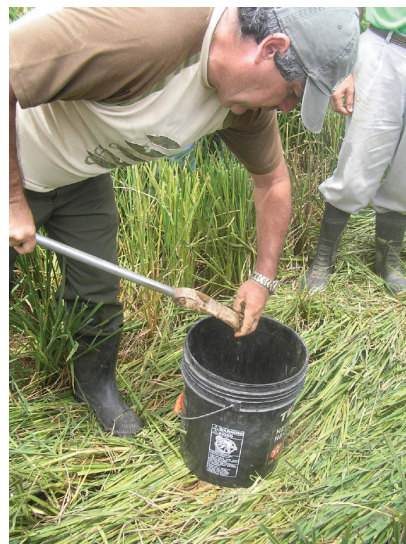
Figura 11. Recolección y mezcla de submuestras
